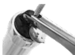
4. otočte pístnici se zářezy k páce, nastavte regulátor síly sušenek
