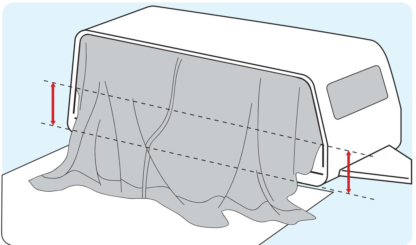
**!** Achten Sie darauf das Sie das Zelt nach dem Einziehen gleichmäßig ausrichten. Ein nachträgliches anpassen ist nachher nicht mehr möglich.
