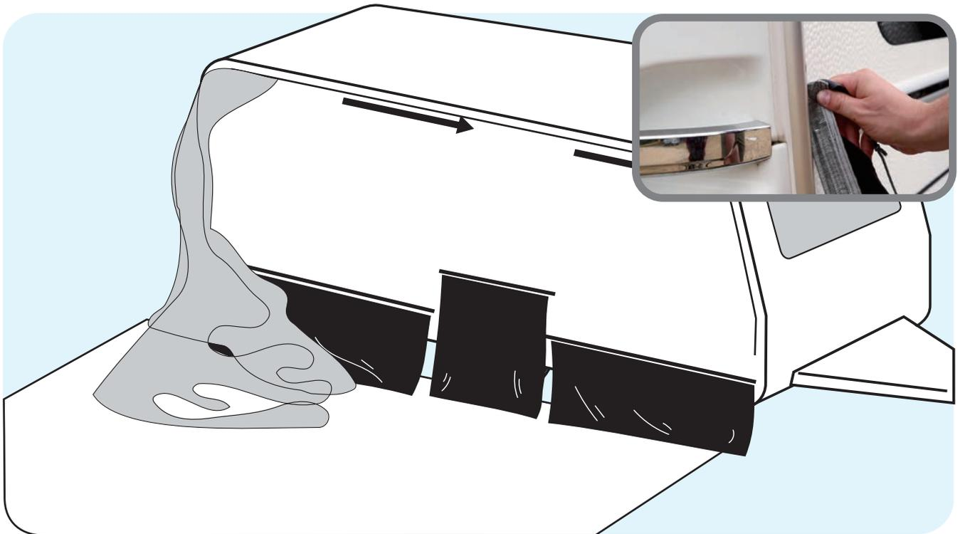
Für einen erleichterten Aufbau beim einkedern empfehlen wir alle Wandelemente zu entfernen. Ziehen Sie das Vorzelt in die Kederschiene ein und richten Sie es aus.
