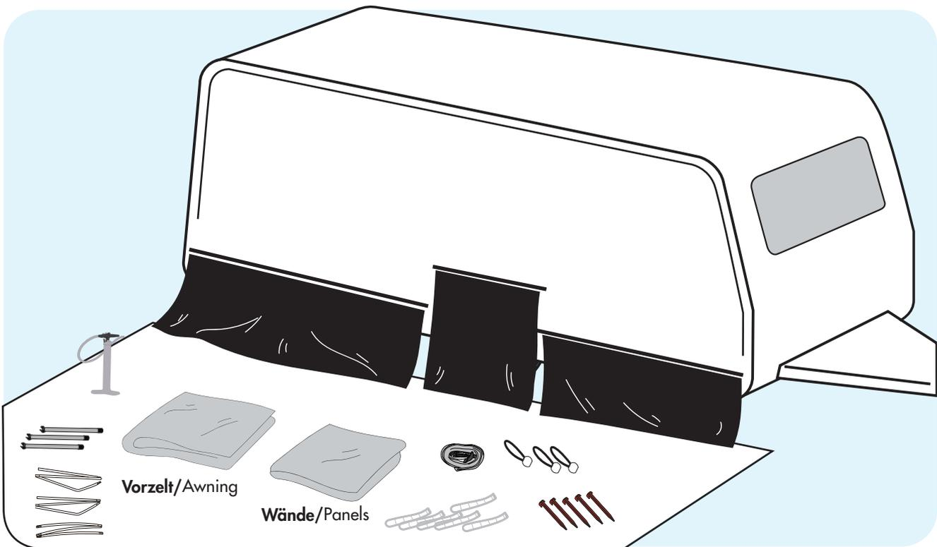
**Bei Bedarf schieben Sie die Windschürze in die dafür vorgesehene Kederschiene unten am Fahrzeug. Befestigen Sie dann die Radabdeckung in der vorgesehenen Halterung oder verbinden Sie diese mit der Windschürze mittels der mitgelieferten Doppelkederschiene.**
