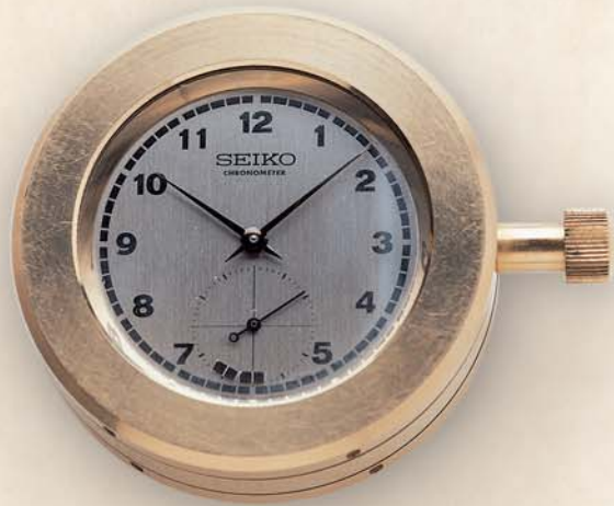
Ezt a második generációs szerkezetet használták az 1966-68 közötti kronométer versenyeken. A billegő frekvenciáját másodpercenként 10-re növelték, és a nagyobb korona könnyebbé tette a felhúzást
