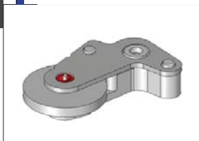
A piezo motor utáni, a hajtást biztosító első kerék
